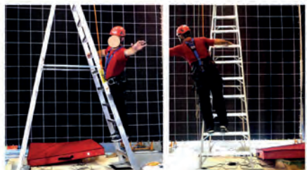
Vérification de la stabilité de l'escabeau – Position 2 : côté (P2).
