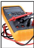
Le multimètre est sûrement l'instrument le plus utilisé par tous les professionnels de l'électricité. Peu de personnes sont au courant qu'il existe 4 catégories de multimètres. Une sélection adéquate est un critère de sécurité important. En d'autres mots : la plupart mettent leur sécurité en
