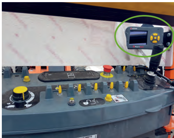
Exemples de dispositif de limitation de portée sur équipements. (Source RaycoWylie)
