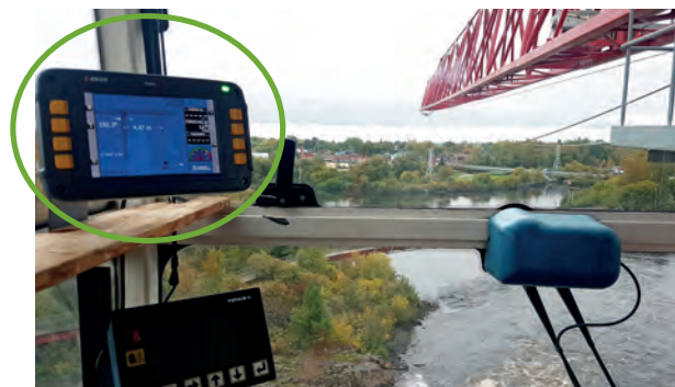
Exemples de dispositif de limitation de portée sur équipements. (Source RaycoWylie)
