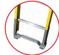
Le pied de chaque montant est muni d'un patin antidérapant en bon état, et les éléments de fixation sont présents et bien serrés.
