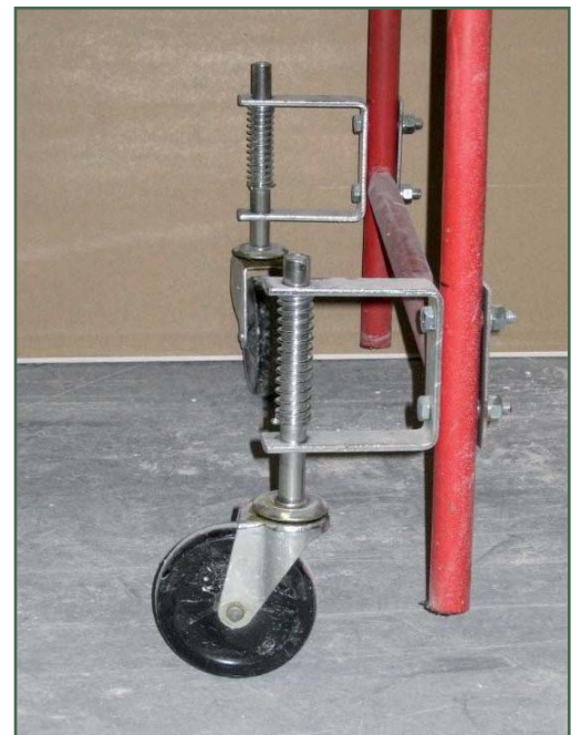
Le poids du travailleur déclenche automatiquement le verrouillage des roues.
