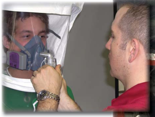
Marc Côté, conseiller en prévention, effectuant un essai d'ajustement qualitatif d'un appareil de protection respiratoire.
